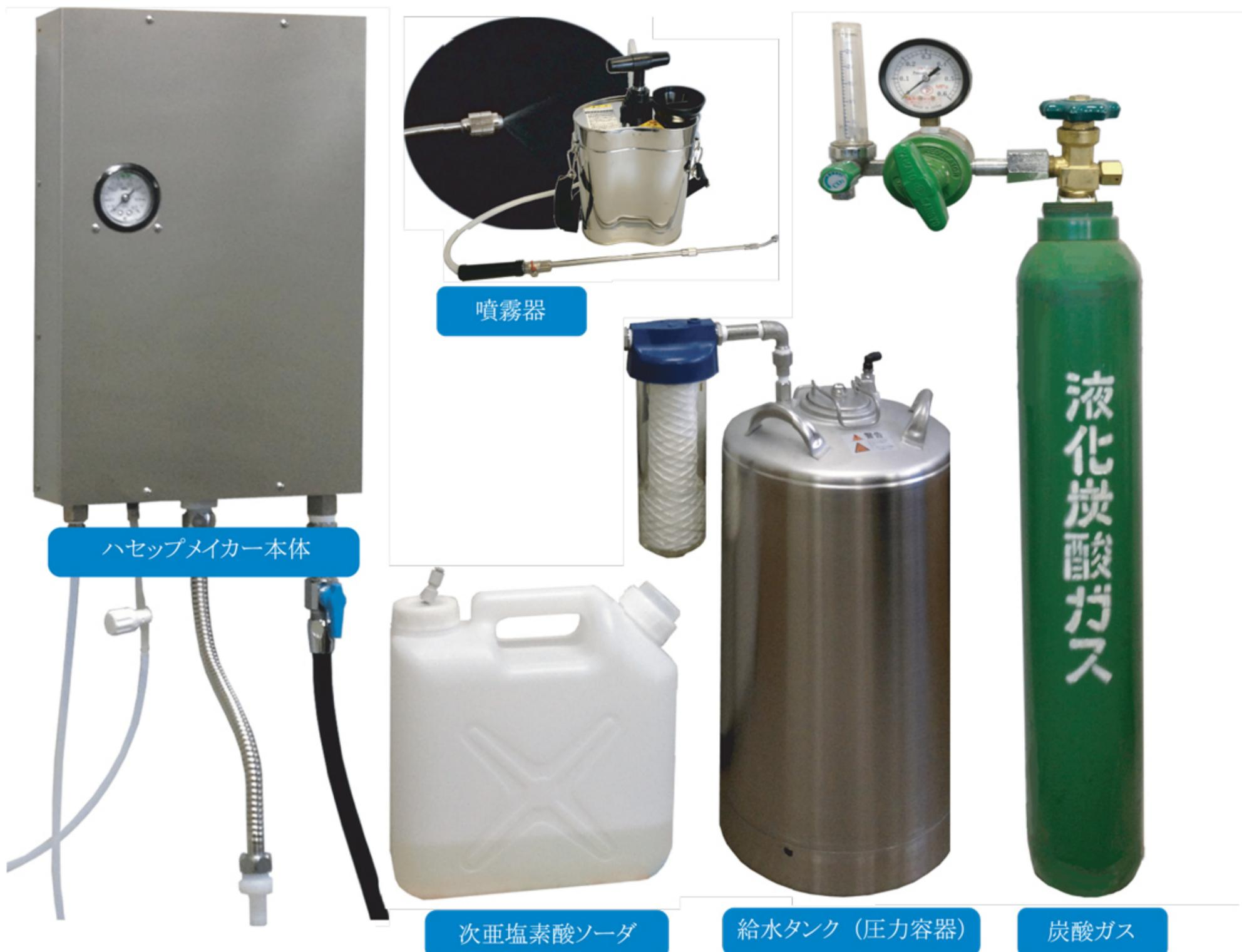
災害時には、水道・電気・ガスなどのライフラインが途絶えることがあります。そして、衛生管理もままならない状態が予想されます。このハセップメーカー (HM-310) は、水 (雨水や溜水など) と次亜塩素酸ナトリウムと炭酸ガスがあれば電気を使わずに弱酸性の殺菌水を作ることができます。食器やまな板の除菌はもちろん、生ゴミや汚物の消臭、手指の洗浄などあらゆる場面で役に立ちます。
